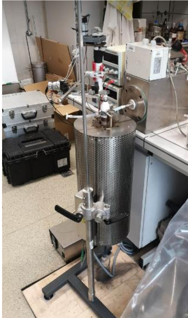
Rys. 6. Laboratoryjny generator spalin
