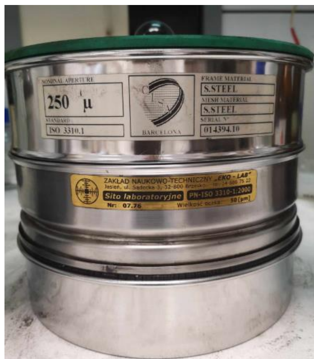
Rys.14. Układ sit używanych do przesiewania węgla brunatnego.
