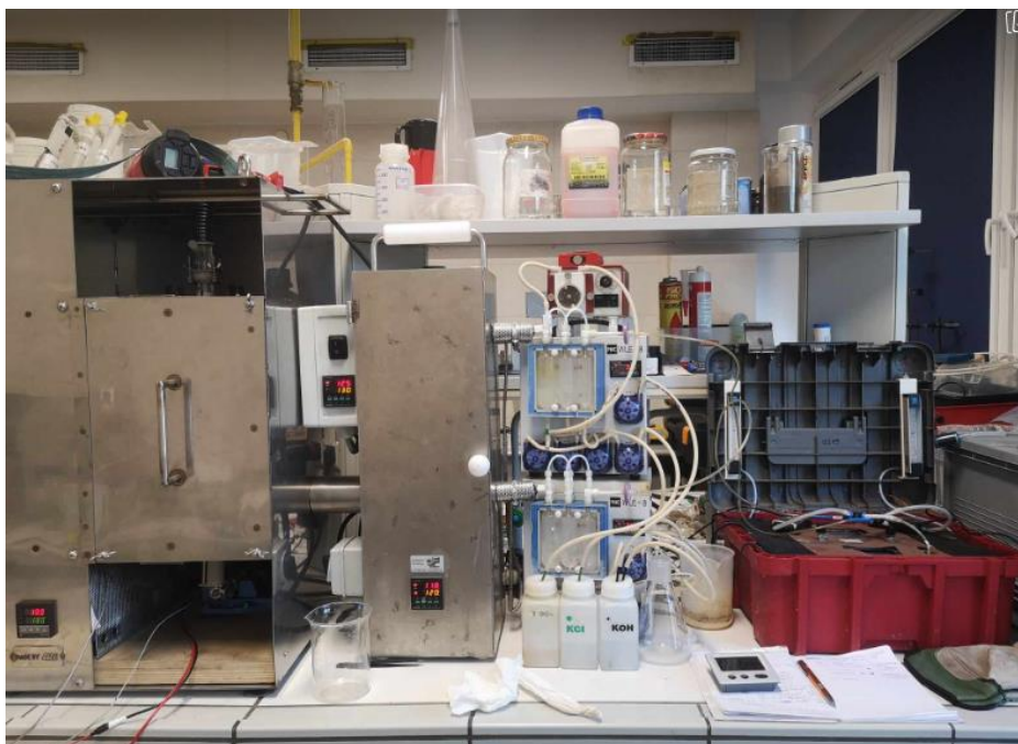
Rys. 11. Kolejno od lewej: wibracyjny moduł do testów sorbentów, trójnik, zestaw płuczek WLE-8, detektory EMP-2.
