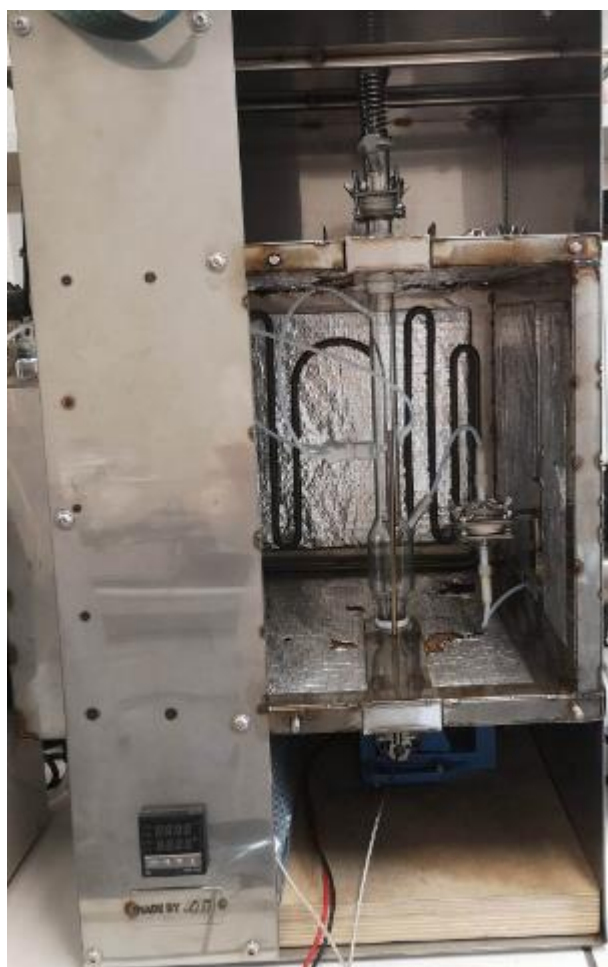
Rys. 8. Wibracyjny moduł do testów sorbentów
