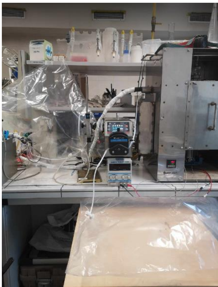
Rys. 7. Pompa perystaltyczna firmy Nippon oraz worek Tedlar zawierający pary rtęci elementarnej.
